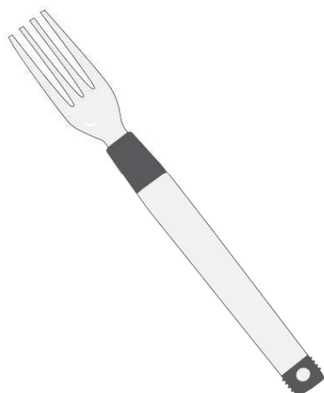
Fourchette intelligente = Tête + Manche + Clé électronique
